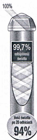
Rys 6. Ilustracja działania rur przekazujących światło naturalne
